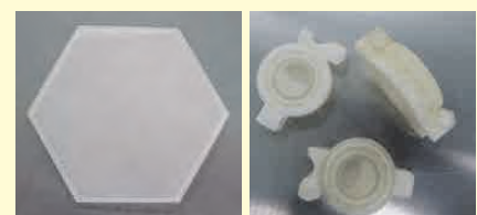
3Dプリンタで作成したベアリング各種
