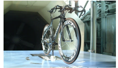
トライアスロン用競技自転車の風洞実験 (於:川崎重工業(株))
